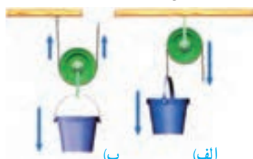
شکل ۱۲- قرقره ثابت و قرقره متحرک
