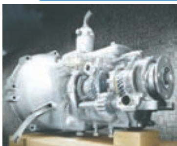
شکل ۱۵ - ترکیب پیچیده‌ای از چرخ‌دنده در جعبه‌دنده خودرو
