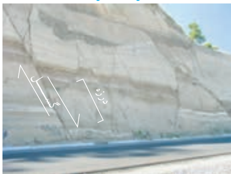
شکل ۱۵- مقایسه درزه و گسل (آذربایجان شرقی)
