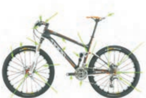
شکل ۳ - دوچرخه از اجزا یا ماشین‌های ساده‌تری مانند: اهرم، پیچ و مهره، چرخ و محور، دنده و... تشکیل شده است.
